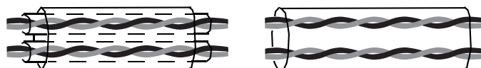
Figuur 22 Links een dubbelafgeschermd kabel met getwiste aderpairs en rechts een enkelvoudig afgeschermd meerparige kabel.
